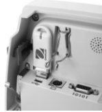
Conexiones de la interfaz dentro del terminal.
