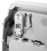
Les raccords d'interface à l'intérieur du terminal.
